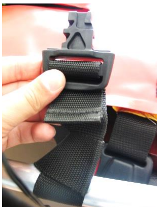
Obr. 4-11 Provlečení popruhu včetně spony „samec“
