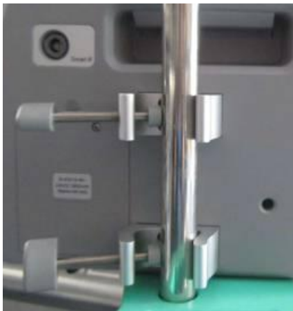
Obrázek 5.1 Instalace pumpy na infuzní stojan
